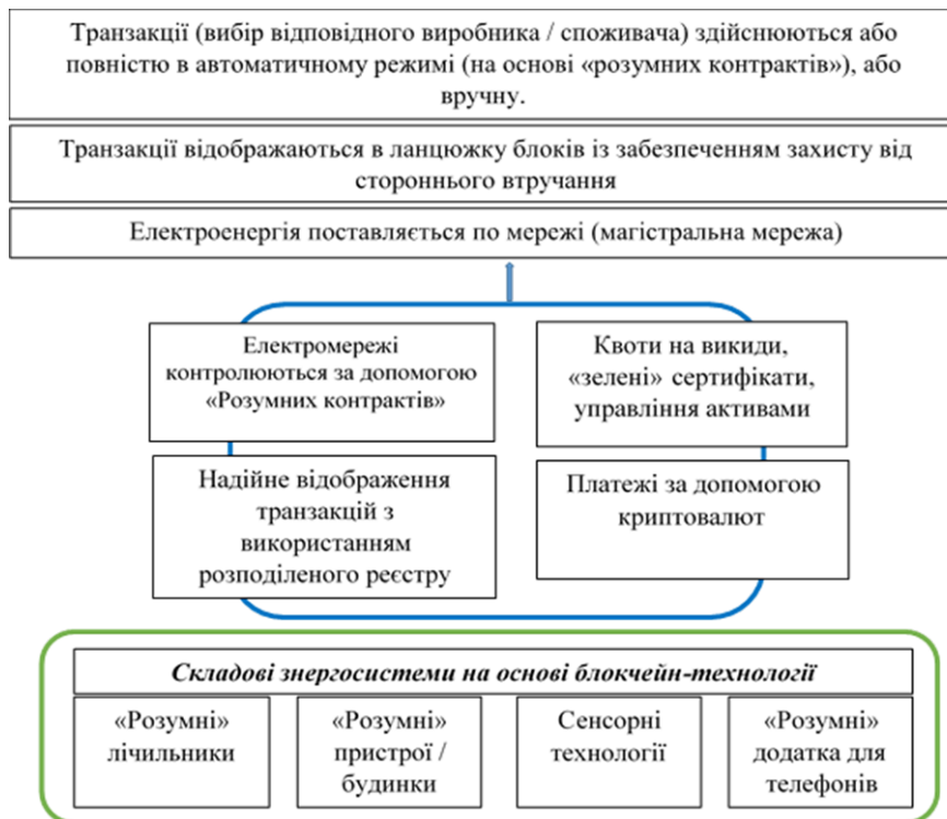
Рис. 1. Децентралізована система енергетичних транзакцій та енергопостачання
